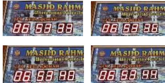
Gambar 5. Pengujian Tampilan *Seven Segment* Waktu (jam, menit, detik)
