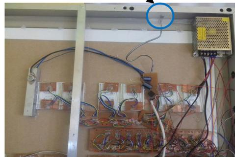
Gambar 2. Bingkai Aluminium Sebagai Peredam Panas (*Heat Sink*)
